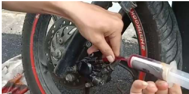
Gambar 1.9 Proses Bleeding Pada Rem Hidrolik (Cakram) Sumber: Syaifi Abdurrahman
