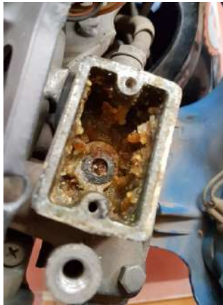
Gambar 1.3 Minyak Rem yang Sudah Berubah Bentuk Sumber: Syaifi Abdurrahman
