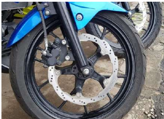
Gambar 1.8 Rem Hidrolik (Cakram) Pada Motor Satria FU Sumber: Syaifi Abdurrahman
