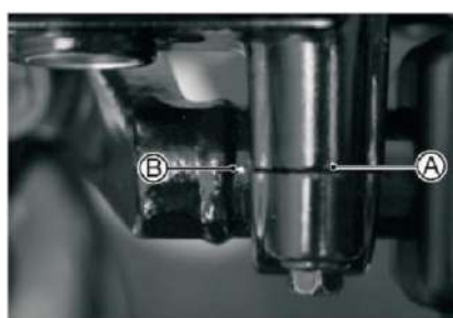
Gambar 1.46 Master Cylinder A dengan Tanda B pada Kemudi Sumber: Indomobil Suzuki International, 2010
