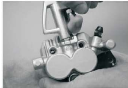
Gambar 1.27 Caliper dihembuskan dengan Udara Bertekanan Sumber: Indomobil Suzuki International, 2010
